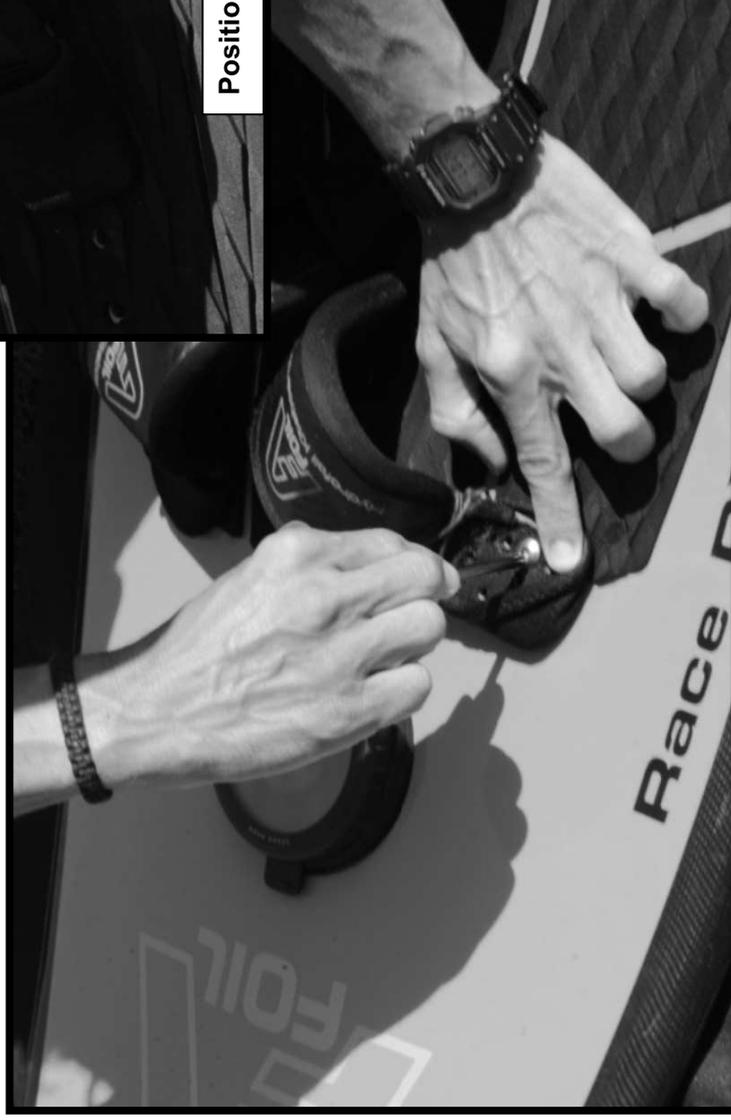
Strap en V – Positionnement au plus proche de l'axe longitudinale de la planche
