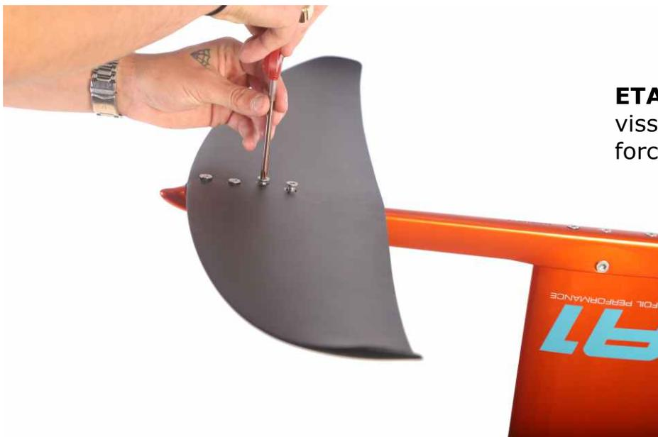
**ETAPE 15 :** À l'aide d'une clé TORX, vissez les quatre vis pour atteindre une force de 5 Newton.
