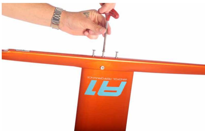
**ETAPE 11** : À l'aide d'une clé TORX, vissez les deux vis TX30-8 pour atteindre une force de **3 Newtons MAX.**
