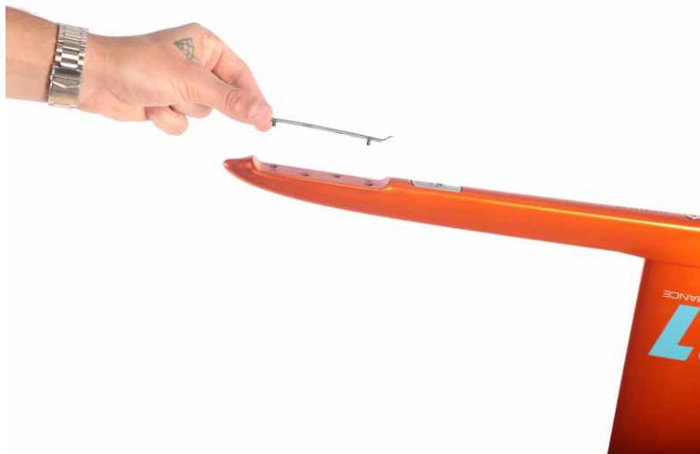
**ETAPE 12 :** Déposez la cale GIS 0° (réglage de base) pour l'aile avant. flèche vers l'avant
